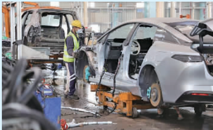
■优湃能源科技(广州)有限公司的工人正在对报废车进行拆卸作业。新华社记者 钟焯 摄
