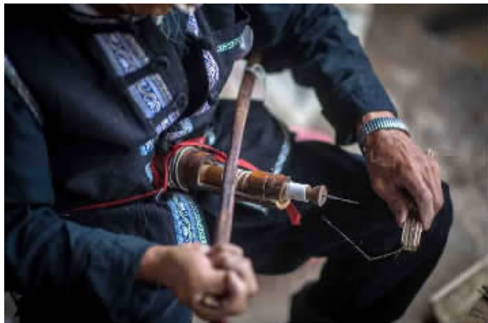
◆张荣华老人使用专门的工具为伞骨钻孔
